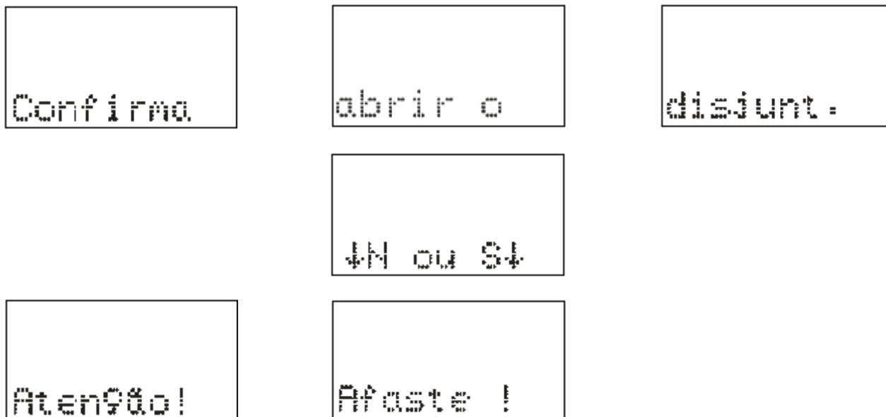
Figura 3.12: Comando local para abrir o disjuntor.
