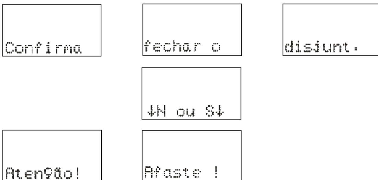
Figura 3.10: Comando local para fechar o disjuntor.
